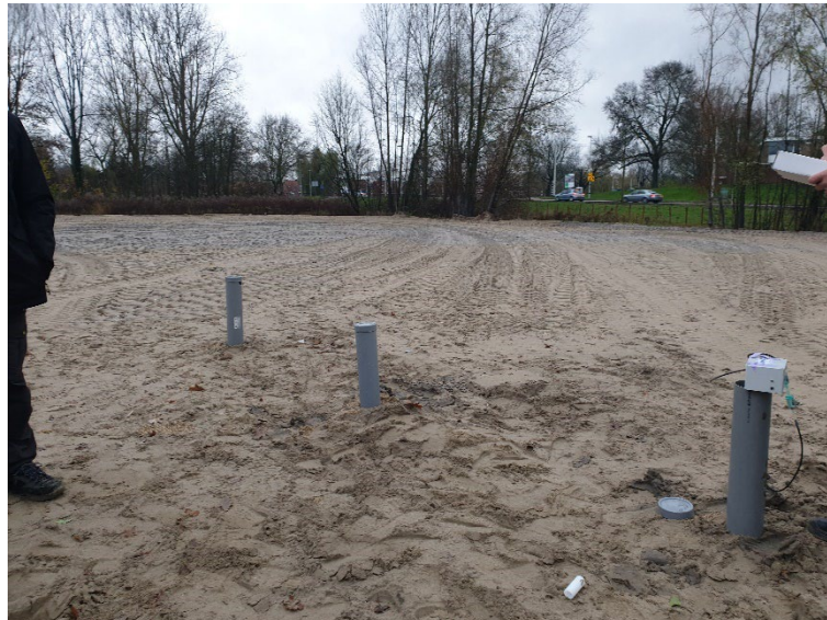
Figuur 57: Drie nieuwe peilbuizen Dwarsdijk West
