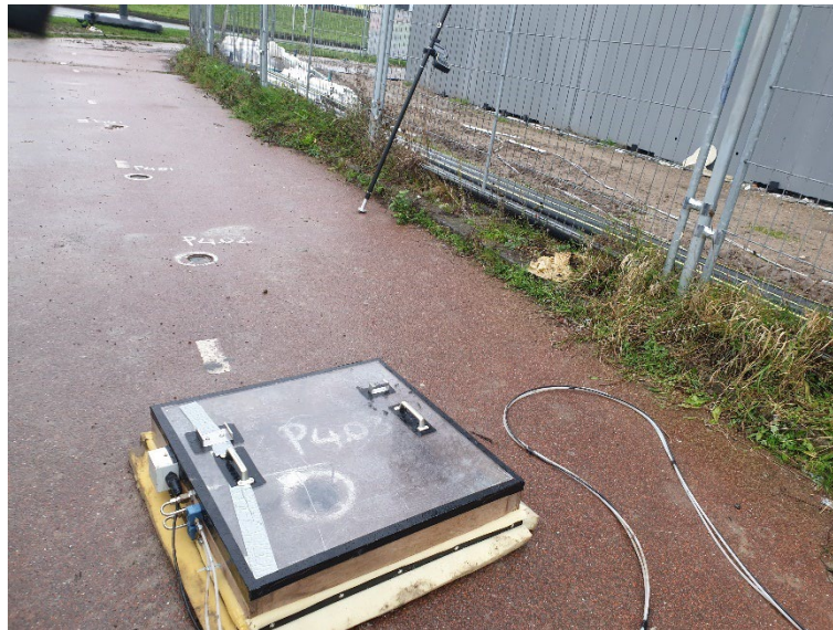
Figuur 51: Boxmetingen boven peilbuizen in fietspad, zowel met als zonder dop erop
