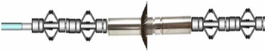
Figuur 5: Multifinger tool met 2 centralizers aan boven- en onderkant en uitstaande vingers in het midden
